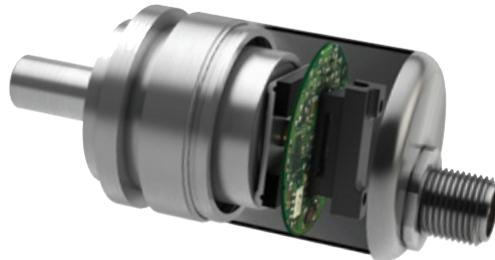
Magnetische Drehgeber bestimmen eine Winkelposition mithilfe von Magnetfeldsensoren, die auf dem Hall-Effekt basieren. Ein Dauermagnet **A**, der an der Welle des Drehgebers befestigt ist, erzeugt ein Magnetfeld, das vom Sensor **B** gemessen wird, der wiederum einen eindeutigen, absoluten Positionsmesswert erzeugt.
